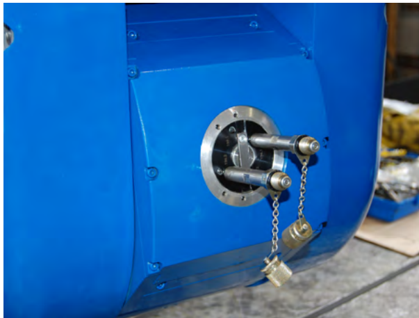
Anschlussverschraubungen an den Entlüftungsbohrungen der Spindel (Einbauposition)
