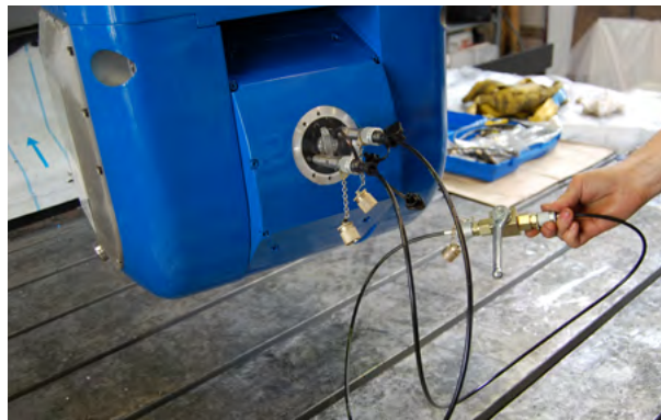
Entlüftungsset mit geschlossenem Absperrhahn
